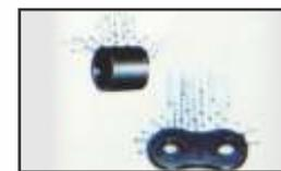
**Peças pequenas:** As placas de ligação e os rolos passam pelo processo de granalhagem para maior resistência à fadiga.
